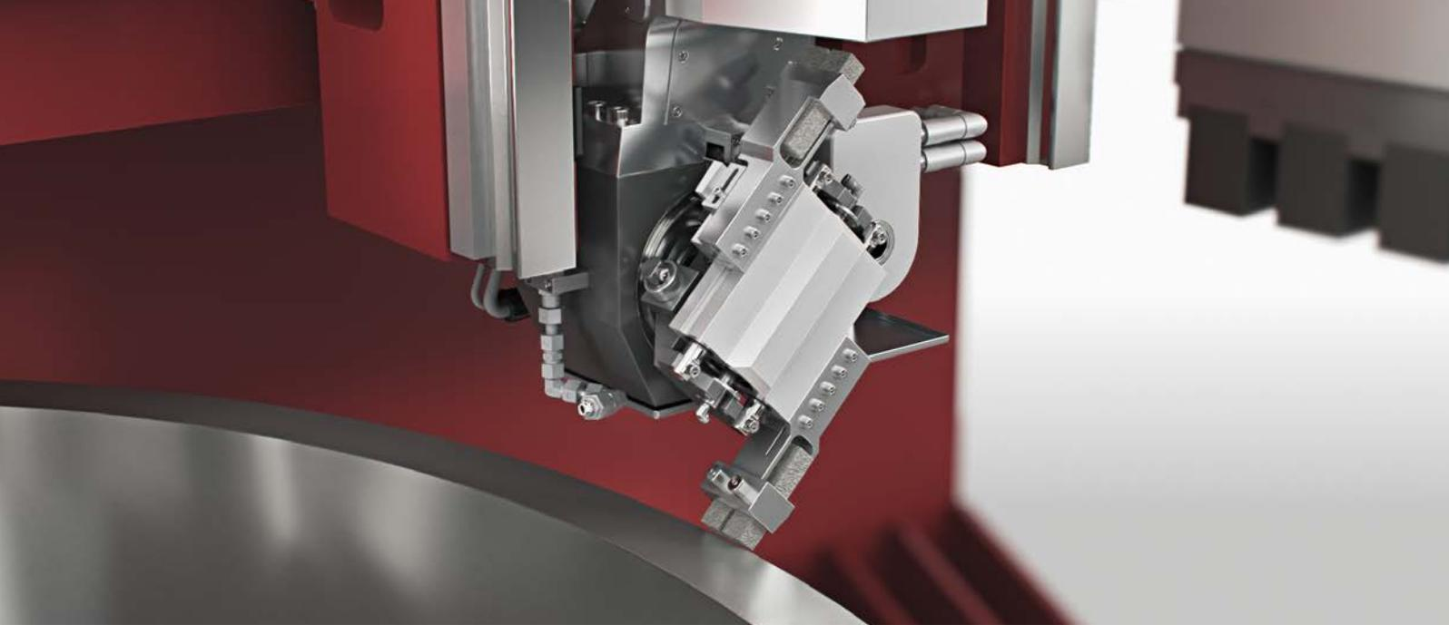
Vertikale Maschine mit Steinhonvorrichtung.
