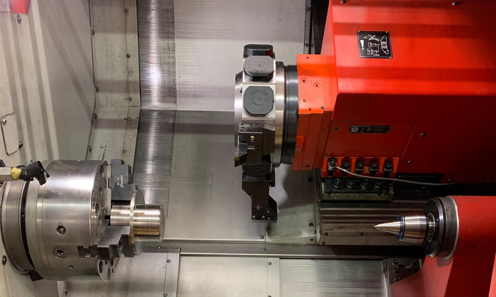
Drehmaschine mit installiertem Kraftsensor 9102C unter Revolver – Befestigungselement.
