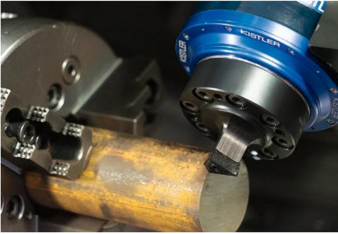
森拉天时采用9171A型四分量旋转式切削力测力计（RCD）测量切削力。压电传感器技术赋予RCD超高采样率和灵敏度，以及极宽的力测量范围。
