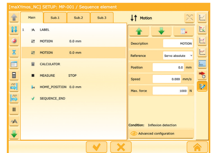
Für jedes der bis zu 128 Programme besteht die Möglichkeit, einen unabhängigen Ablauf zu definieren.
