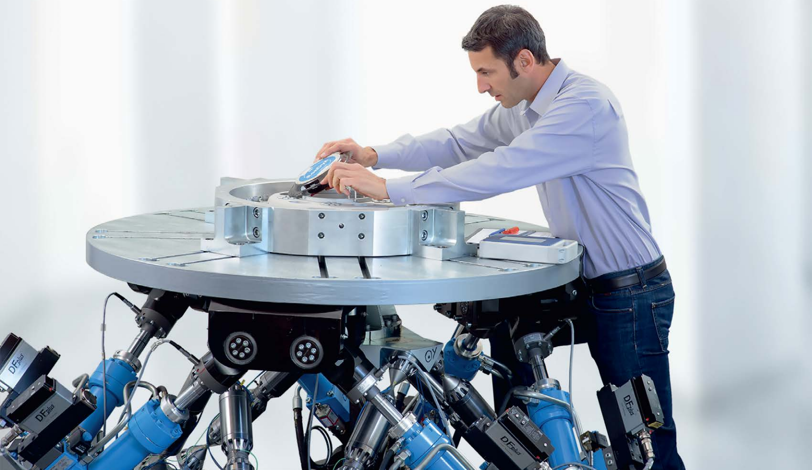
在六轴校准台上校准RoadDyn车轮力传感器
